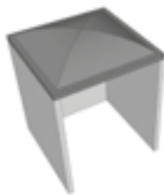
Soffitto a padiglione Cloister vault ceiling
